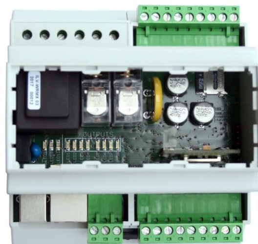
Obrázek 14: Výsledná pozice modulu uvnitř regulátoru.
